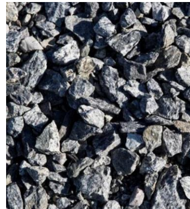
Figur 5. Ballast till vägbeläggningar utgörs idag av krossat berg, även kallad jungfruligt stenmaterial, eller returafalt (RAP). Tillgången till ballast med god kvalitet är i allmänhet bra i Sverige men kan variera mellan olika regioner (Jacobsson, 2015).
